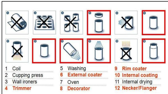
Figura n. 1 - Utilizzo del vuoto nella produzione di lattine Immagine gentilmente concessa da Rexam
